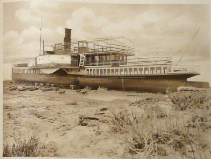
Flottnachung eines bei Hochwasser aufgelaufenen Personendampfers bei Wesel (Ansicht von der Landseite)
